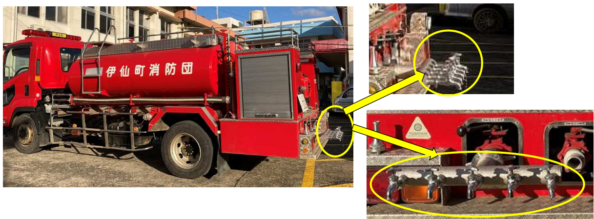
写-10 応急給水(消防給水車への蛇口設置)
