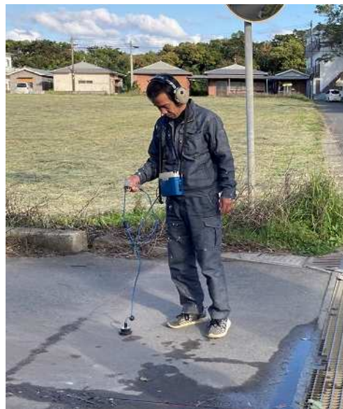
写-12 職員による漏水調査
